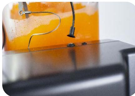
Conectores magnéticos de la luz de las tolvas, que simplifican la desconexión al retirarlas y evitan rupturas.
